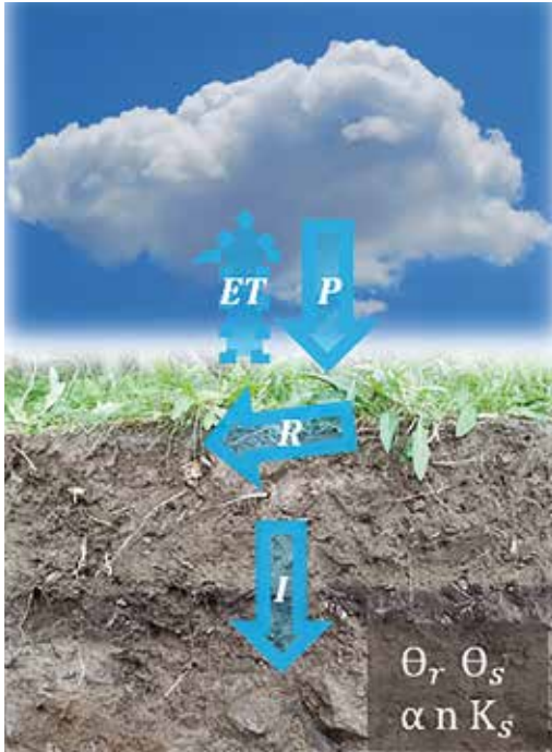
Figur 3. Konceptuell bild av transportprocesser som HYDRUS-1D beskriver och vilka parametrar som nyttjas. ET: evapotranspiration, P: nederbörd, R: ytavrinning, I: infiltration, samt hydrauliska markparametrar: \Theta_r : residuala vatteninnehållet, \Theta_s : mättat vatteninnehåll, K_s : mättad hydraulisk konduktivitet, \alpha och n är kurvparametrar.
