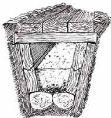
Figur 3. Överdäckade avloppsdiken, så kallade Skvalbänkar (runt 1850), skiss från Cronström (1986).
